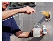
"Wichtig ist, dass die Füll- und Entlüftungsleitungen der Trinkwasseranlage mit MultiNox Schlauchrein ebenfalls gereinigt werden" sagt Gelzhäuser, "sie sind eine der Hauptquellen für die Wiederverkeimung".
